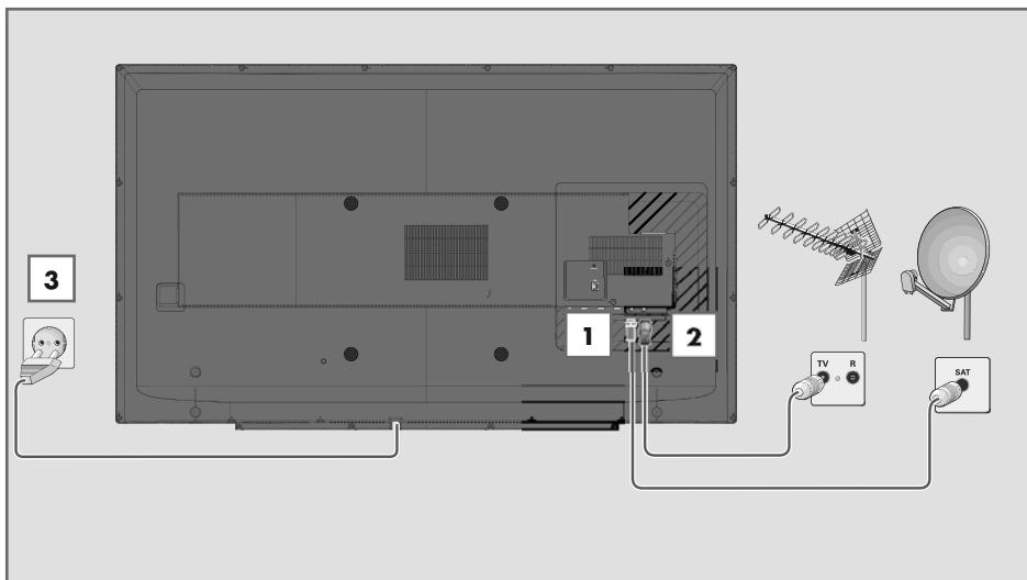
**1a** Zum Empfang digitaler Satellitenprogramme (DVB-S) das Kabel der Satellitenantenne an die Antennenbuchse **SATELLITE** am Fernsehgerät anschließen.
