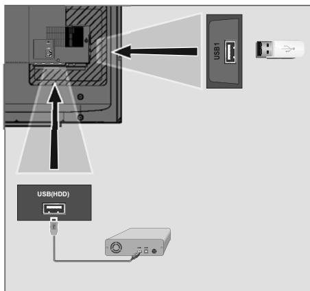
1 Buchse **USB(HDD)** des Fernsehgerätes und entsprechende Buchse des Datenträgers (externe Festplatte) mit einem USB-Kabel verbinden;
